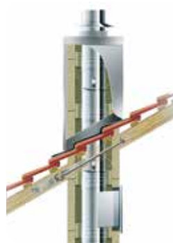
Beispiel: Stülpkopf Alu als Verkleidung über Dach.
