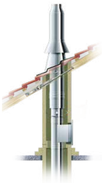
Beispiel: doppelwandiges Edelstahlelement als Verkleidung über Dach.
