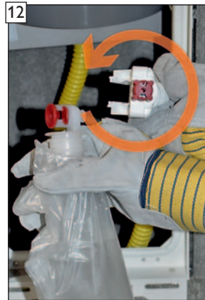
Verriegelung des BIB-Connectors (Drehung gegen den Uhrzeigersinn) öffnen und BIB-Anschlusshahn mit dem Kondensatauffangbeutel aus dem Kupplungsteil herausziehen.
