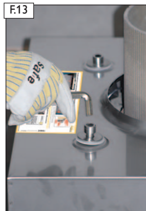
F13 3. Edelstahl-Inbusschrauben M12 handfest anziehen .
