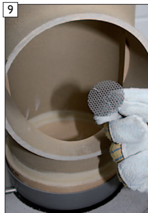
Ein Grobfilter ist in der Fußschale eingesteckt. Dieser ist regelmäßig von Grobschwebeteilchen zu reinigen.
