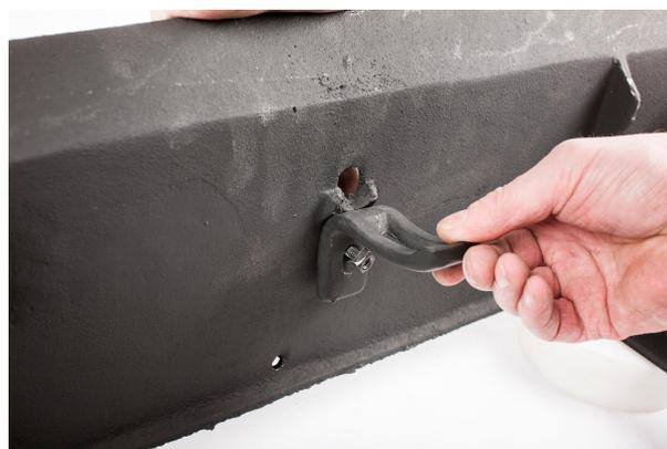
7. Læg låget til spjældet på plads, og sæt betjeningsstangen ned i styreskinnen, så hullet i betjeningsstangen passer i fatningen i låget. Sæt nu splitten gennem hullet, og buk enderne ud med en tang.
