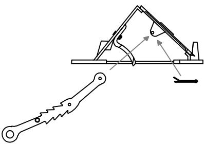
**Fig 3.** Før palarmen gennem hullet i afstandsholderen og centrer armens Ø6,5 mm hul mellem lågets Ø6,5 splithuller.
