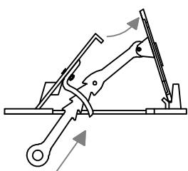
**Fig 5.** Spjældet installeres som vist i monteringsanvisningen. Såfremt der er behov for en længere palarm, kan armen spejlvendes hvorved længden forøges.
