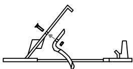
**Fig 1.** Placér afstandsholderen ud for centerhullet på indersiden af spjældet og fastspænd med vedlagte Ø6 mm skruer og møtik.
