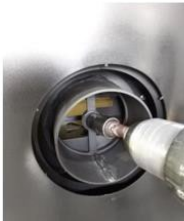
Uchycení přívodu vzduchu šroubem M8
