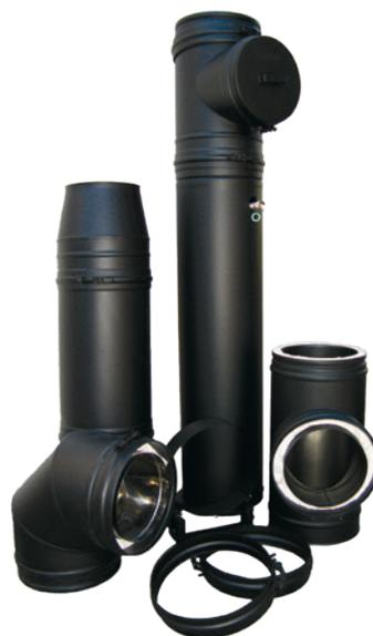
Das PERMETER-Innenrohr ist aus Edelstahl mit der Werkstoff-Nr. 1.4521 gefertigt. Der Außenmantel besteht aus pulverbeschichtetem Stahl und übernimmt die statischen Lasten. Der Zwischenraum ist mit einer 25 mm (bzw. alternativ 50 mm) dicken, speziellen „Super-Wool“ gefüllt.
