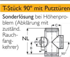
**T-Stück 90° mit Putztürenanschluss rund - Festbrennstoff**
