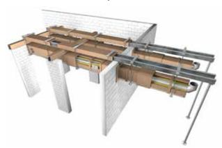
Abgasleitungen führen häufig durch unterschiedliche Brandabschnitte. Um den damit verbundenen hohen Brandschutzanforderungen gerecht zu werden, hat Schiedel sein bewährtes LB 90 System erneut erweitert und konnte eine weitere Prüfung erfolgreich absolvieren.
