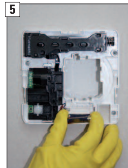
5 Batteriewechsel durchführen. Erforderliche Batterien: 2x 1,5V AAA-Alkaline ACHTUNG: Polarität beachten!
