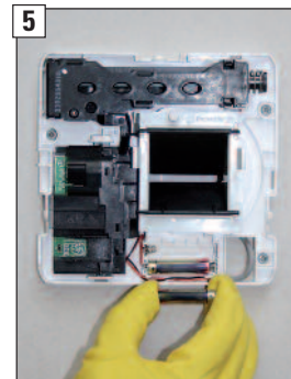
5 Batteriewechsel durchführen. Erforderliche Batterien: 2x 1,5V AAA-Alkaline ACHTUNG: Polarität beachten!
