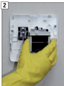
Klappenkasten mit 2 Fingern nach vorne herausnehmen.
