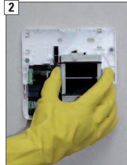
2 Klappenkasten mit 2 Fingern nach vorne herausnehmen.
