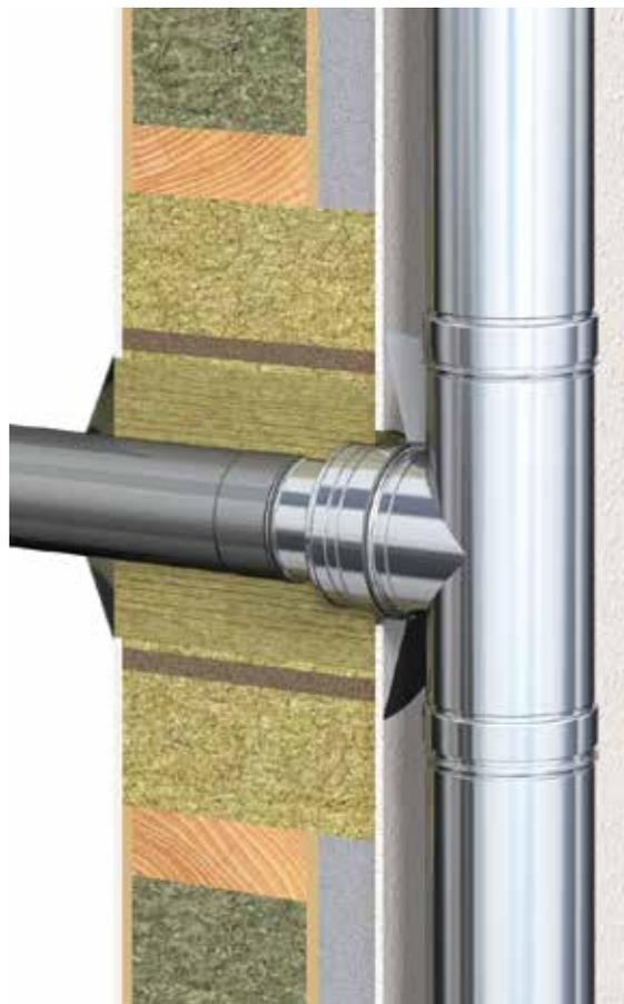
Schiedel **IGNIS PROTECT ULTRA** ist die erste Wanddurchführung mit **ETA-Zertifizierung (ETA-23/0439)** und **CE-Kennzeichnung**. Sie ist für ein- und doppelwandige Verbindungsleitungen bis 450 °C / 600 °C zugelassen.
