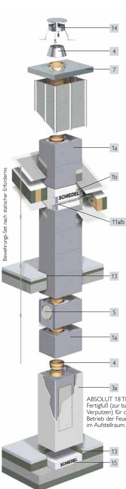
ABSOLUT 18TL optional mit Design-Fertigfuß (zur bauseitigen Verkleidung, z.B. Verputzen) für den raumluftunabhängigen Betrieb der Feuerstätte bei Montagebeginn im Aufstellraum.
