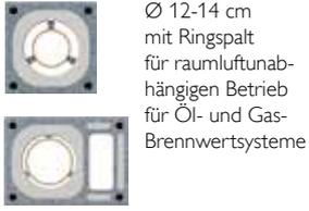
Ø 12-14 cm mit Ringspalt für raumluftunabhängigen Betrieb für Öl- und Gas-Brennwertsysteme
