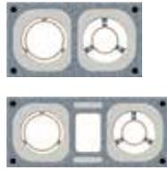
Ø 12-14 cm mit Ringspalt für raumluft-unabhängigen Betrieb für Öl- und Gas-Brennwertsysteme
