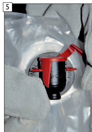
5 Siegel am BIB-Anschluss hahn entfernen.
