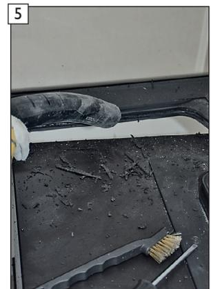
5 Abschließend die Halteleiste mit Staubsauger nachreinigen.
