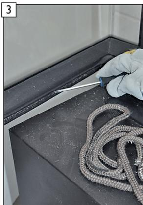
3 Klebereste aus der Rille der Halteleiste mit Schraubenzieher entfernen und ...
