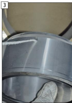
Das Knotenende der E-Glas Flachdichtung in den Knotenfänger des Anschlussfutters einhängen.
