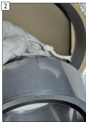
An einem Ende der E-Glas Flachdichtung einen Knoten binden.
