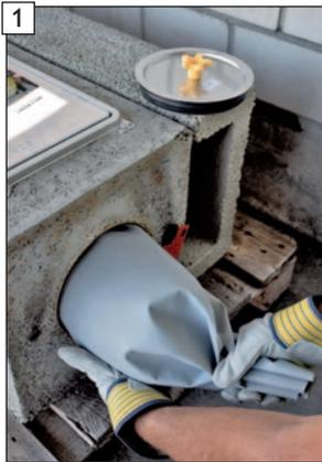
1 Revisionsverschluss „B“ entfernen und Kleinteilebeutel herausziehen.
