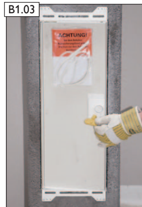
... entriegeln dann die BlowerDoor Design-Fertigfußtür mit dem PT-Schlüssel.
