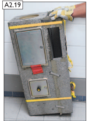
Der Fertigfuß kann nun sofort in vorbereitetes Mörtelbett versetzt werden. WICHTIG! Spanngurte frühestens nach 48 Std. lösen!
