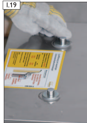
Abdeckkappen in Inbus-schrauben eindrücken.
