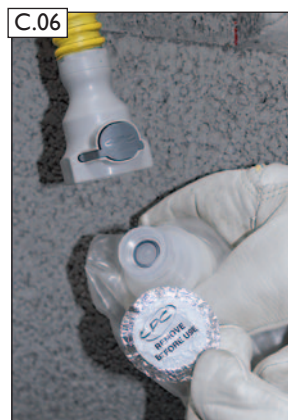
C.06 Die Versiegelung an der Adapterkupplung des leeren Kondensatauffangbeutels entfernen.
