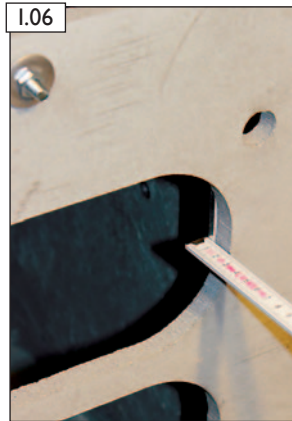
Ermittlung der Aufbauhöhe.
