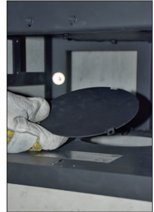
Revisionsdeckel im Geräteboden abnehmen.
