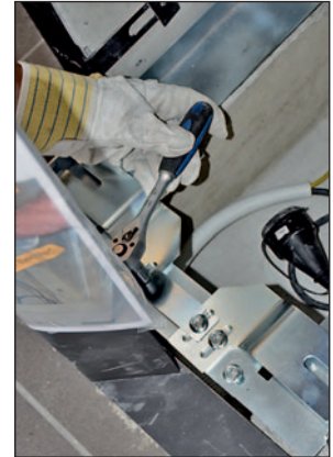
Befestigungsschrauben der linken Halteklammer lösen und ...
