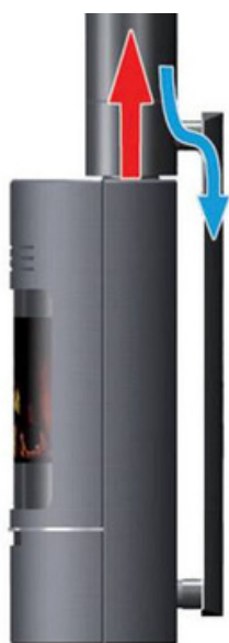
Med tilluftskanal bak oven
