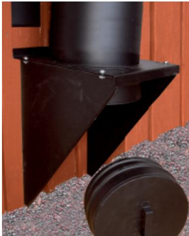
I bunnen av pipa er det åpent og her skal det monteres et isolert lokk med drenering. Lokket kan enkelt fjernes for uttak av sot. Hvis det ikke er tilgang for feiing fra tak kan pipa feies fra bunnen. Påse tilstrekkelig adkomst for feier.
