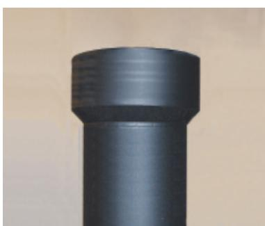
Overgangen mellom halvisolert og helisolert plasseres som regel under den første takgjennomføring. Overgangen kan også skjules i bjelkelaget, men husk da og benytte dekkring for halvisolert.
