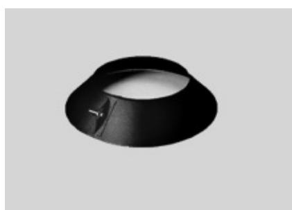
Regnkrave kan benyttes som tetting mellom piperør og membran der hvor membranen tekkes opp på pipa. Benytt tettetmasse i overgang regnkrave/piperør. Denne tettetmassen må vedlikeholdes minimum hvert 3 år og husk værbestandig tettetmasse.
