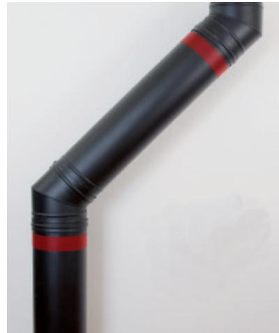
Sørg for at pipa står i lodd. Monter veggforankringer på annenhver meter.
