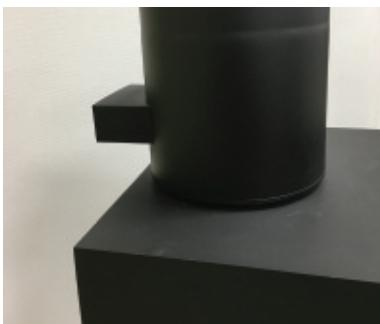
Plasser startrøret direkte på ildstedet og benytt ovnskitt eller flytende fiberpakning for optimal tetting. Den nederste delen kan kappes, eventuelt forlenges med en uisolert forlenger 250 mm som tilpasses på stedet. Sørg for en luftespalte på minimum 5 mm mellom ildsted og pipe. Hvis uttaket på ovnen er 125 mm benyttes en overgang 150 - 125 samt ett pyntedeksel som skjuler overgangen. Ved montering av Schiedel ildsted med "Rett i Toppen" benyttes Schiedel startkobling.
