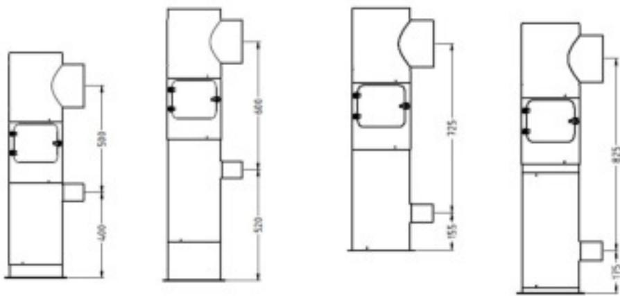
L-rør fås til både Permeter og Permeter Vent. L-rørene består bunnplate (som kan skrus til gulvet ved behov) teleskopiske deler (en med åpning for sotluke og en med stuss for tilkobling av forbrenningsluft for Permeter Vent) samt et T-rør isolert.
