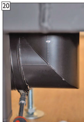
20 Svorka na hadici na ohybovom adaptéri sa teraz môže definitívne dotiahnuť.
