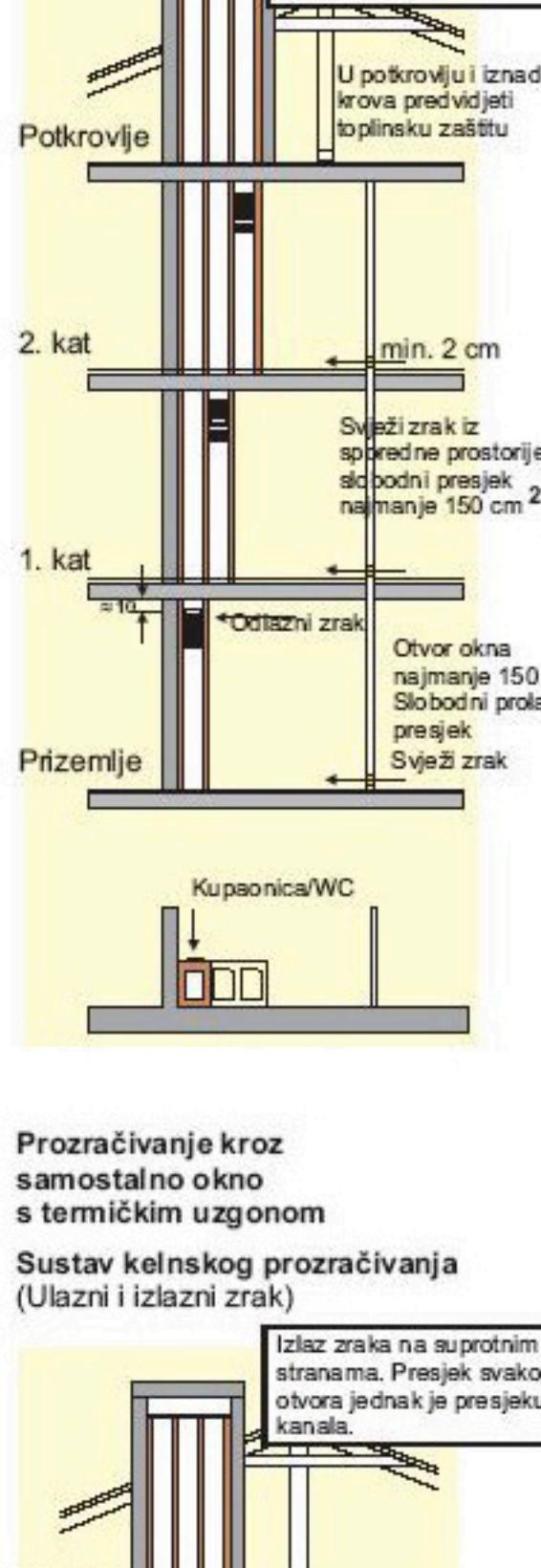
Predstavljaju najbolju izvedbu sustava za prozračivanje koji počiva na načelu termičkog uzgona. Kod viših objekata se veći potrebnii prostor potpuno izjednačuje sa zračnim vodovima sabirnog okna, na osnovu većeg učinka prozračivanja. Kod prozračivanja sa samostalnim oknom se svaki prostor, iz kojeg je potrebno odvesti zrak, priključuje na vlastito okno za prozračivanje sa svjetlim presjekom od  $150 \text{ cm}^2$ .
