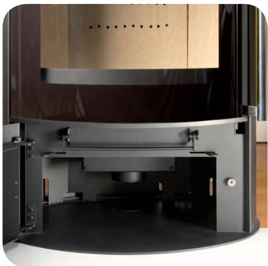
Il vano sottoanta, utile anche per stoccare piccoli accessori, ospita le leve di regolazione dell'aria primaria per l'accensione e la combustione (dx) e dell'aria secondaria di post-combustione (sx), necessaria per ottimizzare il rendimento della stufa e il consumo di legna
