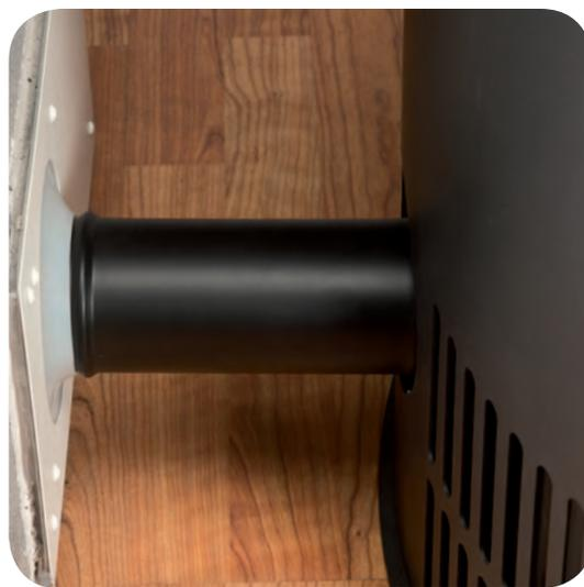
L'adduzione dell'aria comburente è canalizzabile verso l'esterno grazie all'apposita predisposizione posta nella parete posteriore della stufa, in posizione retrostante, bassa e non visibile; la canalizzazione consente la creazione di un circuito chiuso dell'aria senza dover forare in facciata né compromettere l'involucro dell'abitazione, requisito indispensabile per case passive e ad alta efficienza: nessuna dispersione d'aria e di calore.
