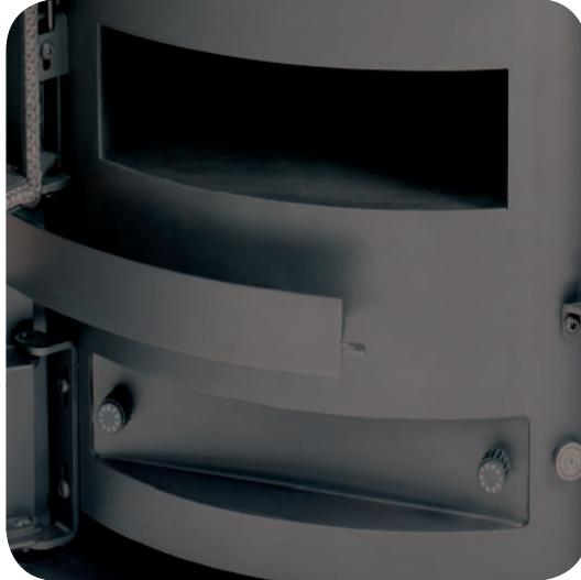
Lo sportello inferiore cela un piccolo vano sotto l'anta che ospita le manopole di regolazione dell'aria primaria per l'accensione e la combustione (dx) e dell'aria secondaria di post-combustione (sx), necessaria per ottimizzare il rendimento della stufa e il consumo di legna. Il modello LARI si distingue per un meccanismo aggiuntivo di regolazione automatica che controlla l'immissione dell'aria primaria all'interno del focolare migliorando la combustione e il rendimento della stufa.
