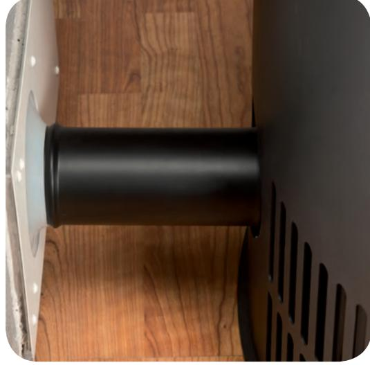
L'adduzione dell'aria comburente è canalizzabile verso l'esterno grazie all'apposita predisposizione posta nella parete posteriore della stufa, in posizione retrostante e non visibile; la canalizzazione consente la creazione di un circuito chiuso dell'aria senza dover forare in facciata né compromettere l'involucro dell'abitazione, requisito indispensabile per case passive e ad alta efficienza: nessuna dispersione d'aria e di calore.
