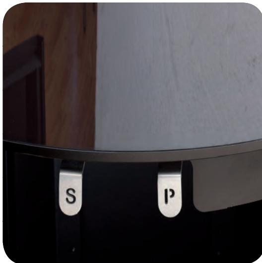
Il pratico vano sottoanta, utile anche per stoccare legna o piccoli accessori, ospita le leve di regolazione dell'aria primaria ("P") per l'accensione e la combustione (dx) e dell'aria secondaria ("S") di post-combustione (sx), necessaria per ottimizzare il rendimento della stufa e il consumo di legna.
