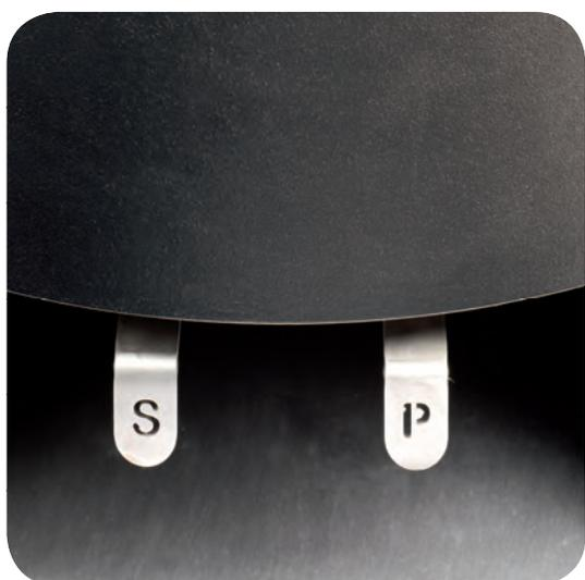
Il pratico vano portalegna sotto l'anta ospita le leve di regolazione dell'aria primaria ("P") per l'accensione e la combustione (dx) e dell'aria secondaria ("S") di post-combustione (sx), necessaria per ottimizzare il rendimento della stufa e il consumo di legna.
