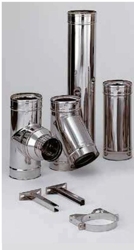
Sistema camino marcato CE a doppia parete in acciaio inossidabile **ICS5000 (Inox-Inox)**, precoibentato con lana ceramica SUPERWOOL. Parete interna in acciaio AISI 316 L spessore 25 mm, parete esterna in acciaio inox AISI 304 (14031) con finitura lucida BA. Tenuta fino a 5000 Pa e resistente fino ai 600°C di temperatura. Idoneo ad ogni impianto di tipo civile o industriale e per ogni combustibile (V3 secondo UNITS 11278), per funzionamento a secco (D).
