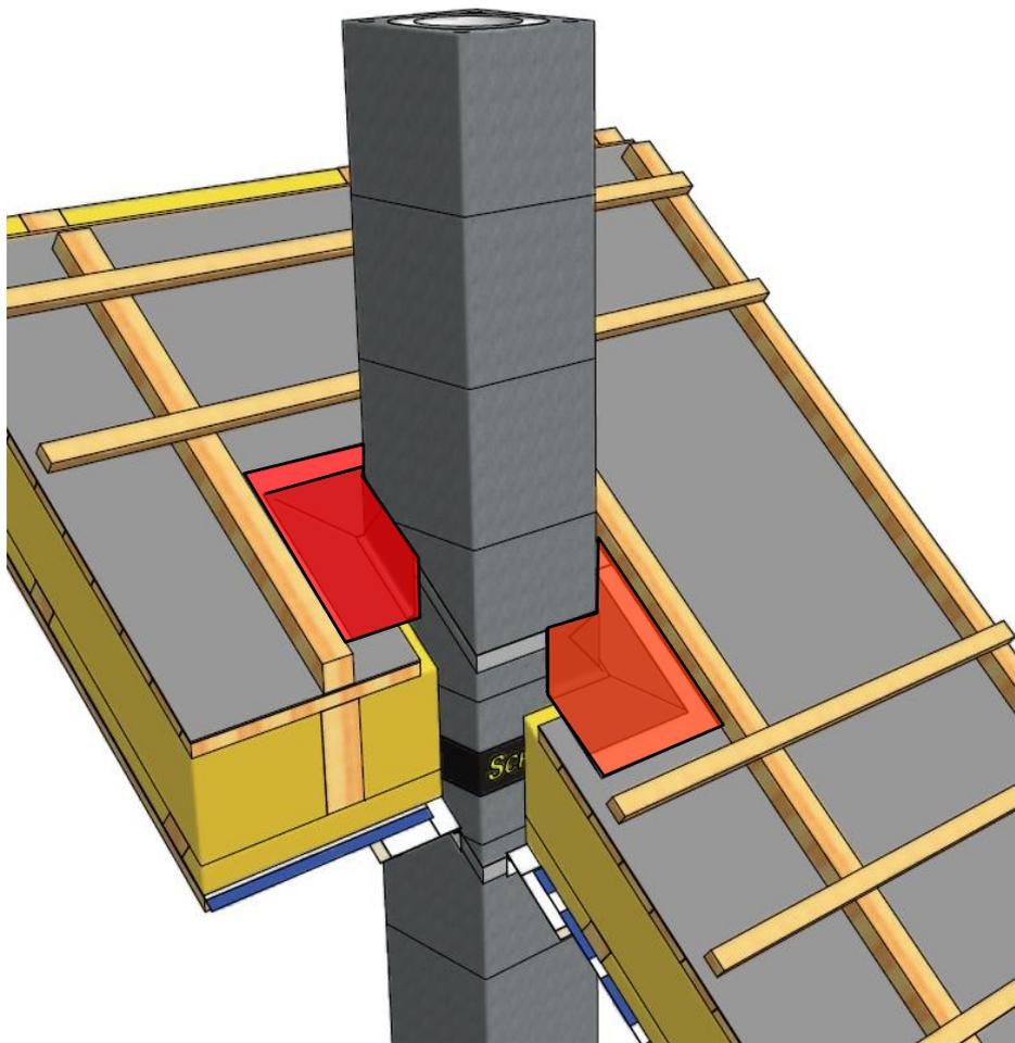
**Med Schiedel tettefolie sikres det mot vannlekkasje over tak.**
