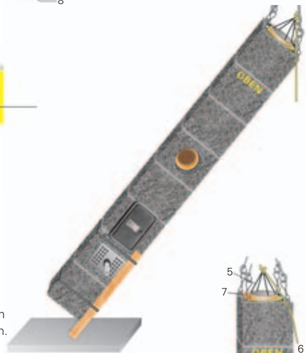
1.3 Upprätta ett underlag för upplyftning av skorstensmodulen. Lyftstöden skall tas bort först när skorstensmodulen är upphissad och hänger fritt i vertikalt läge av lyftanordningen!
