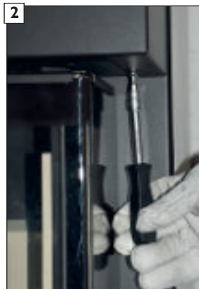
2 Uvoľnite bočné vrchné skrutky
